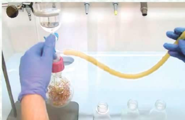
Figura 10.9 Montaje para atrapar \text{NO}_2 .
