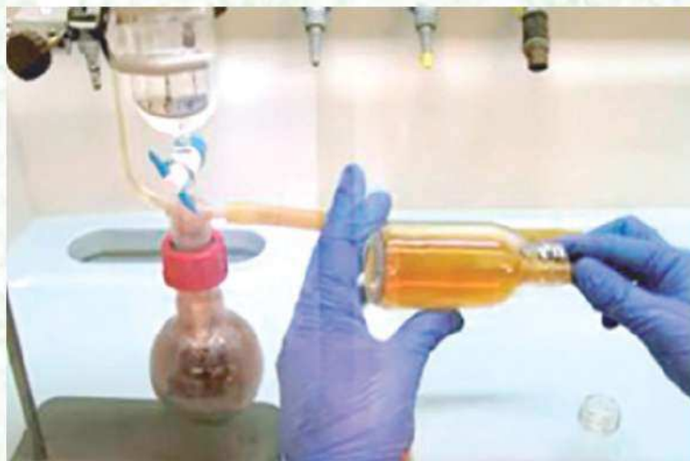
Figura 10.10 Montaje para la producción de \text{NO}_2 .
