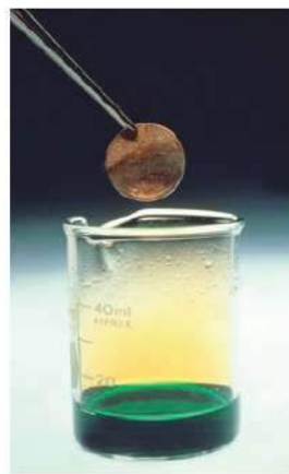
Figura 1.3 El cobre reacciona con ácido nítrico, generando nitrato de cobre (II), un compuesto de color verde y soluble en agua, así como dióxido de nitrógeno, un gas rojizo.
